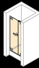
Распашная дверь с дополнительным элементом для ниши
