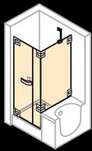
Распашная дверь с дополнительным элементом и короткой боковой стенкой на ванне
