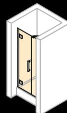
Распашная дверь с дополнительным элементом для ниши
