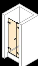
Распашная дверь с дополнительным элементом для ниши
