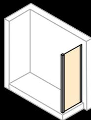
Боковая стенка для 2-секционной раздвижной двери с неподвижными сегментами/раздвижной двери с неподвижным сегментом и дополнительным элементом
