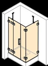
Распашная дверь с неподвижным сегментом, дополнительным элементом и боковой стенкой
