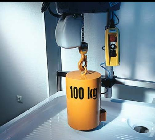
В ходе испытаний выявляется устойчивость душевого поддона к деформации при длительной нагрузке.
