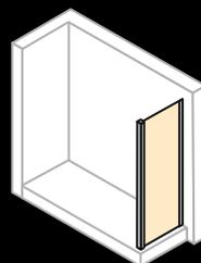
Боковая стенка для односекционной раздвижной двери с неподвижным сегментом
