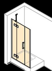
Распашная дверь с неподвижным сегментом и дополнительным элементом для боковой стенки
