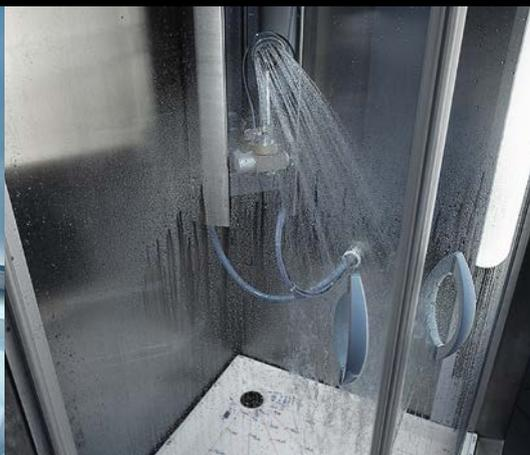
Во время испытания на герметичность проверяется, не попадают ли брызги воды за пределы душевой кабины.
